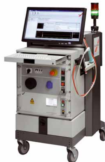
Erstmals auf der ELECTRONICA 2010 vorgestellt: Prüfsystem für Elektrosäulen und Ladekabel
